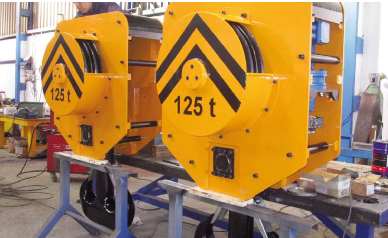
Hook block with motorized rotation of 125 tonnes capacity. Trócola con giro motorizado de 125 tn de capacidad.
