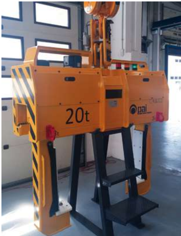
Grabs for coils 20 tonnes with motorized rotation Pinza portabobinas 20 tn con giro motorizado
