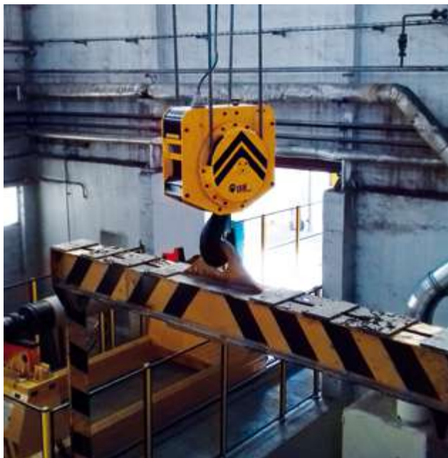
Hook block with weighing system, integrated display Trócola con sistema pesaje, visor integrado
