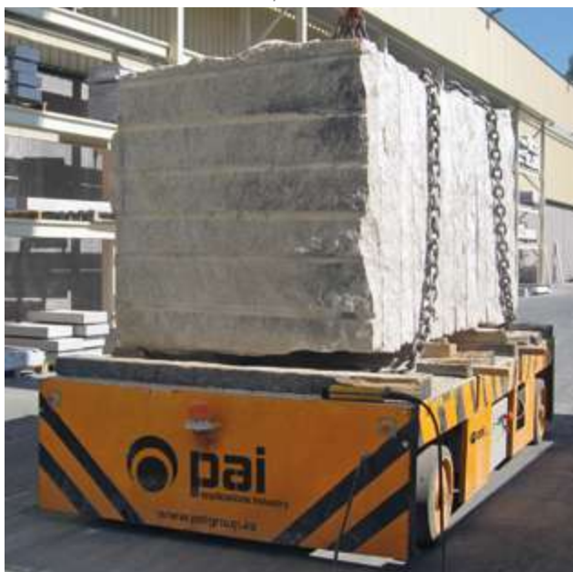
Autonomous trolley 30 tonnes capacity Carro autónomo de 30 tn de capacidad
