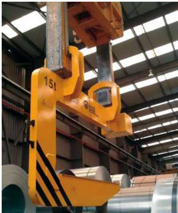
Special C Hook with turning system Gancho C especial con sistema de volteo
