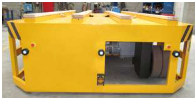
Autonomous trolley 30 tonnes capacity Carro autónomo de 30 tn de capacidad
