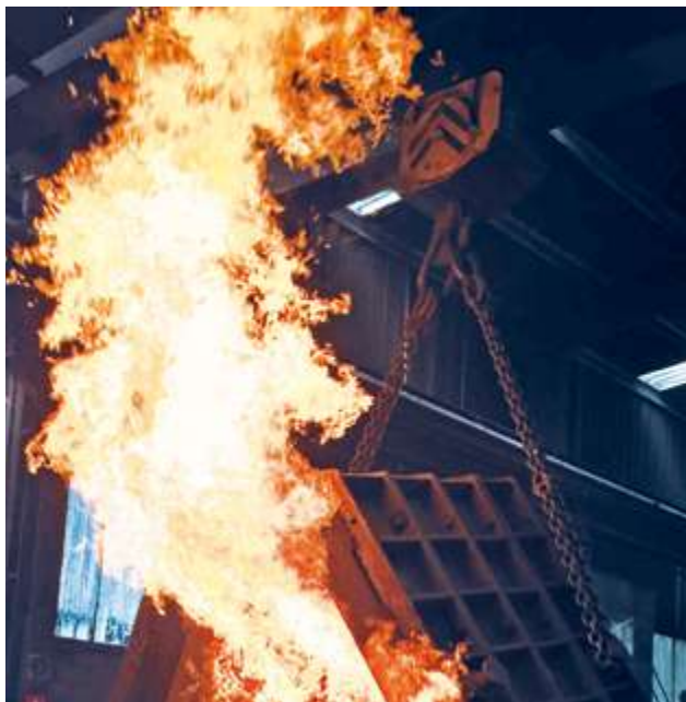
Special Hook block with motorized rotating, high temperatures Trócola especial con giro motorizado, altas temperaturas
