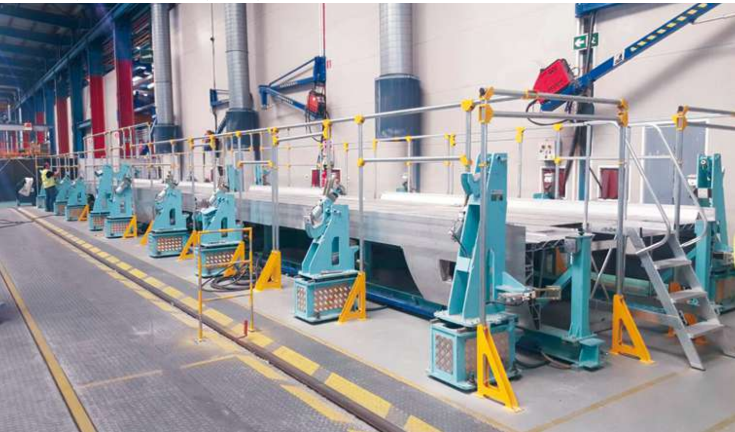
Modular tooling system with perimeter protection Utillajes con sistema modular de protección perimetral
