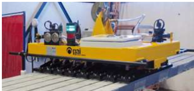
Spreader beam with vacuum system Balancín de carga con sistema de vacío
