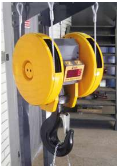
Hook block with weighing system, integrated display Trócola con sistema pesaje, visor integrado
