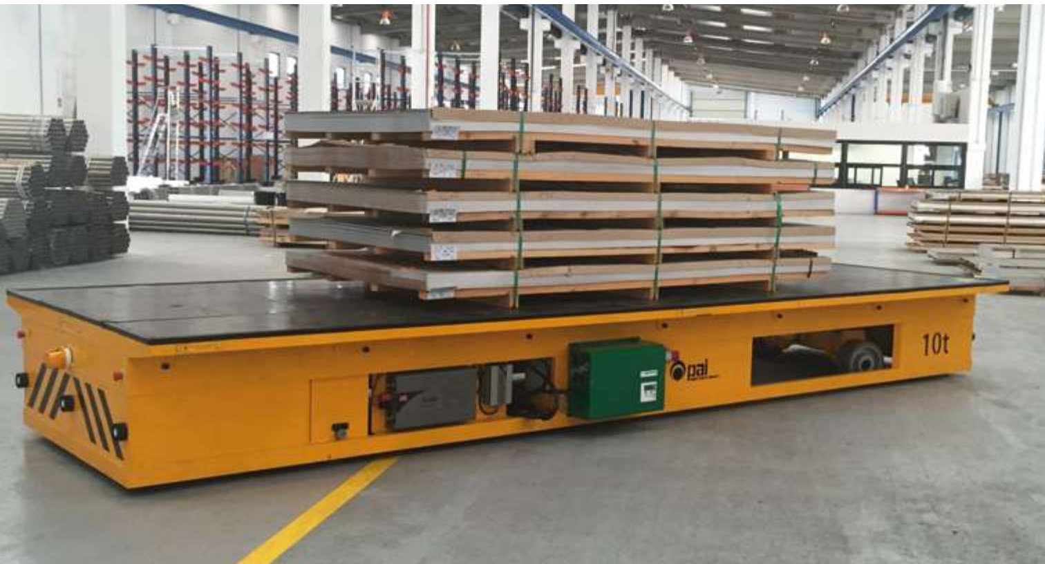
Autonomous trolley 10 tonnes capacity Carro autónomo de 10 tn de capacidad
