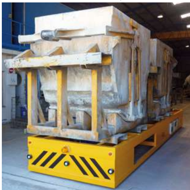
Trolley with electric winder 15 tonnes capacity Carro con enrollador eléctrico 15 tn de capacidad
